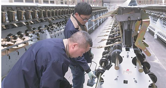
新型智能纺织机械装备,已于去年4月全面投产。在新款TS20D气动倍捻机装配现场,记者看到16台机器分两列排开,10余名工人分别在安装隔板、移丝杆和穿落针,忙得不亦乐乎。直捻制造部负责人梁骏告诉记者,这批产品从正月初八开始装配,21天内必须全部发货,因此这段时间正在加班加点。他们的产品远销越南、南非等国家以及江苏、山东、广东、福建等地,订单已经排到了4月份。
