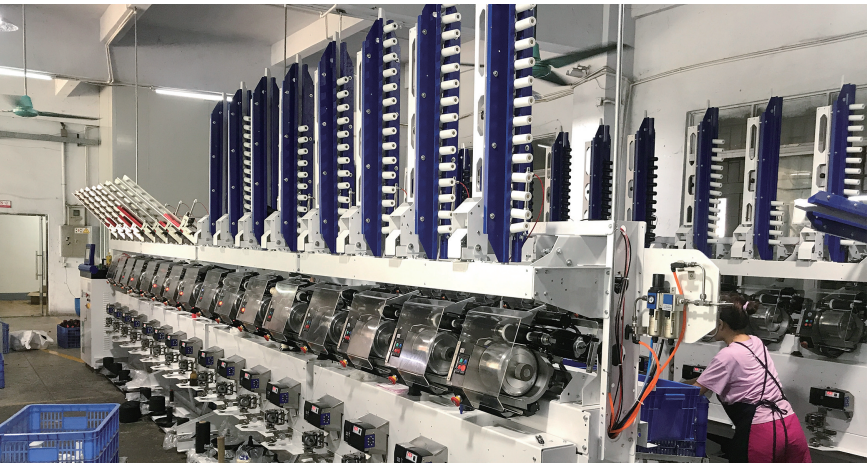
522全自动高速绕线络筒机(俗自动打线机),已经批量在江苏、福建、广东等地稳定使用。图为广州一客户生产现场。
